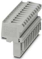
Maschio, tensione nominale: 500 V, corrente nominale: 24 A, numero poli: 11, tipo di connessione: Connessione a molla, Sezione di dimensionamento: 2,5 mm<sup>2</sup>, sezione: 0,08 mm<sup>2</sup>-4 mm<sup>2</sup>, colore: grigio
