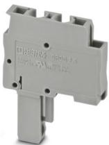
Maschio, tensione nominale: 500 V, corrente nominale: 24 A, numero poli: 1, tipo di connessione: Connessione a molla, Sezione di dimensionamento: 2,5 mm<sup>2</sup>, sezione: 0,08 mm<sup>2</sup>-4 mm<sup>2</sup>, colore: grigio
