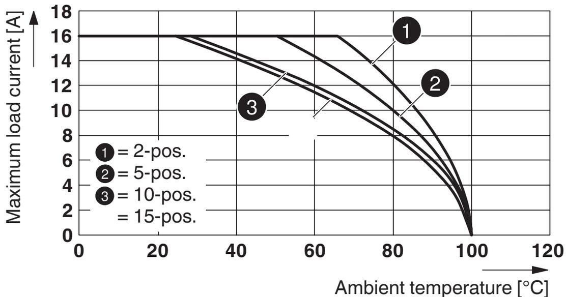
Curva derating per ST 2,5-TWIN-MT/1P, ST 2,5-TWIN-TG/1P e per tutte le varianti di connettori SP...
