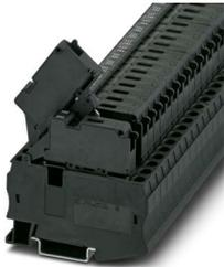
Morsetto portafusibili, tipo di fusibile: Vetro / ceramica / ..., tipo fusibile: G / 6,3 x 32, tensione nominale: 24 V, corrente nominale: 10 A, tipo di connessione: Connessione a molla, 1. piano, Sezione di dimensionamento: 1,5 mm<sup>2</sup>, sezione: 0,08 mm<sup>2</sup>- 6 mm<sup>2</sup>, tipo di montaggio: NS 35/7,5, NS 35/15, colore: nero
