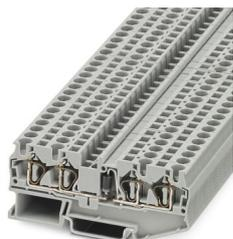
Componente morsetto componibile, con diodo integrato 1N 5408, tensione nominale: 800 V, corrente nominale: 1,5 A, numero di connessioni: 4, tipo di connessione: Connessione a molla, Sezione di dimensionamento: 1 mm<sup>2</sup>, sezione: 0,08 mm<sup>2</sup> - 6 mm<sup>2</sup>, tipo di montaggio: NS 35/7,5, NS 35/15, colore: grigio
