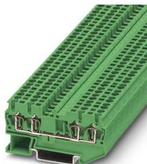
Morsetto passante, tensione nominale: 800 V, corrente nominale: 24 A, numero di connessioni: 4, tipo di connessione: Connessione a molla, Sezione di dimensionamento: 2,5 mm<sup>2</sup>, sezione: 0,08 mm<sup>2</sup> - 4 mm<sup>2</sup>, tipo di montaggio: NS 35/7,5, NS 35/15, colore: verde
