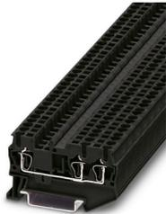
Morsetto passante, tensione nominale: 800 V, corrente nominale: 24 A, numero di connessioni: 3, tipo di connessione: Connessione a molla, Sezione di dimensionamento: 2,5 mm<sup>2</sup>, sezione: 0,08 mm<sup>2</sup> - 4 mm<sup>2</sup>, tipo di montaggio: NS 35/7,5, NS 35/15, colore: nero
