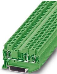
Morsetto passante, tensione nominale: 800 V, corrente nominale: 24 A, numero di connessioni: 3, tipo di connessione: Connessione a molla, Sezione di dimensionamento: 2,5 mm<sup>2</sup>, sezione: 0,08 mm<sup>2</sup> - 4 mm<sup>2</sup>, tipo di montaggio: NS 35/7,5, NS 35/15, colore: verde
