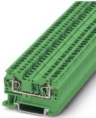
Morsetto passante, tensione nominale: 800 V, corrente nominale: 32 A, numero di connessioni: 2, tipo di connessione: Connessione a molla, Sezione di dimensionamento: 4 mm<sup>2</sup>, 1. piano, sezione: 0,08 mm<sup>2</sup> - 6 mm<sup>2</sup>, tipo di montaggio: NS 35/7,5, NS 35/15, colore: verde
