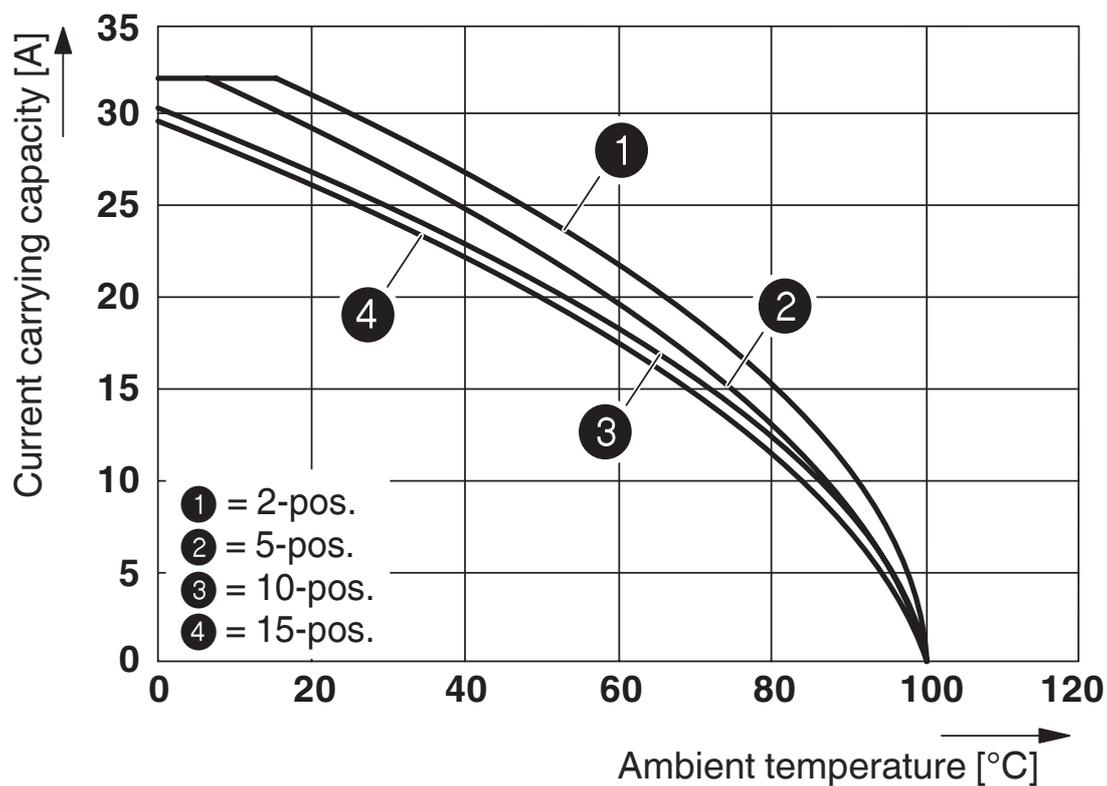
La figura mostra la curva di declassamento del morsetto ST 4... in combinazione con il connettore SP 4
