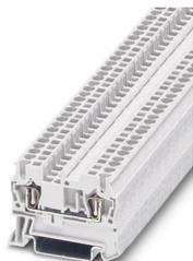
Morsetto passante, tensione nominale: 800 V, corrente nominale: 24 A, numero di connessioni: 2, tipo di connessione: Connessione a molla, Sezione di dimensionamento: 2,5 mm<sup>2</sup>, sezione: 0,08 mm<sup>2</sup> - 4 mm<sup>2</sup>, tipo di montaggio: NS 35/7,5, NS 35/15, colore: bianco
