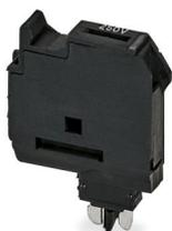
Spina portafusibile, Prima di sostituire il fusibile G, estrarre la spina portafusibile dal morsetto base., tensione nominale: 500 V, corrente nominale: 6,3 A, tipo fusibile: G / 5 x 20, tipo di montaggio: Montaggio a innesto, colore: nero
