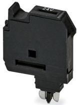
Spina portafusibile, Prima di sostituire il fusibile G, estrarre la spina portafusibile dal morsetto base., tensione nominale: 24 V, corrente nominale: 6,3 A, tipo fusibile: G / 5 x 20, tipo di montaggio: Montaggio a innesto, colore: nero
