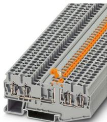
Morsetto con sezionatore a coltello, tensione nominale: 400 V, corrente nominale: 20 A, tipo di connessione: Connessione a molla, Sezione di dimensionamento: 2,5 mm<sup>2</sup>, sezione: 0,08 mm<sup>2</sup> - 4 mm<sup>2</sup>, montaggio: NS 35/7,5, NS 35/15, colore: grigio
