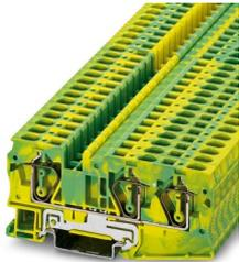
Morsetti comp. per conduttori terra, numero di connessioni: 3, tipo di connessione: Connessione a molla, Sezione di dimensionamento: 6 mm<sup>2</sup>, sezione: 0,2 mm<sup>2</sup> - 10 mm<sup>2</sup>, tipo di montaggio: NS 35/7,5, NS 35/15, colore: giallo-verde
