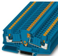
Morsetto sezionatore per conv. misura, tensione nominale: 1000 V, corrente nominale: 30 A, numero di connessioni: 2, tipo di connessione: Connessione Push-in, Sezione di dimensionamento: 6 mm<sup>2</sup>, 1. piano, sezione: 0,5 mm<sup>2</sup> - 10 mm<sup>2</sup>, tipo di montaggio: NS 35/15, NS 35/7,5, colore: blu
