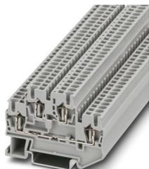
Morsetto a molla a due piani, per il montaggio di componenti selezionabili a piacere, tensione nominale: 500 V, corrente nominale: 22 A, 1. e 2. piano, tipo di connessione: Connessione a molla, Sezione di dimensionamento: 2,5 mm<sup>2</sup>, sezione: 0,08 mm<sup>2</sup> - 4 mm<sup>2</sup>, montaggio: NS 35/7,5, NS 35/15, colore: grigio
