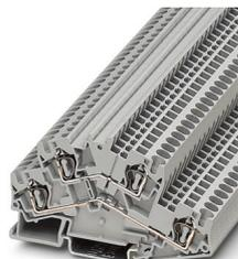
Morsetto a molla a due piani, tensione nominale: 500 V, corrente nominale: 28 A, tipo di connessione: Connessione a molla, 1. e 2. piano, Sezione di dimensionamento: 4 mm<sup>2</sup>, sezione: 0,08 mm<sup>2</sup> - 6 mm<sup>2</sup>, tipo di montaggio: NS 35/7,5, NS 35/15, colore: grigio
