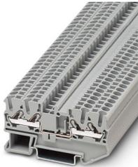
Morsetto passante, tensione nominale: 800 V, corrente nominale: 24 A, numero di connessioni: 4, tipo di connessione: Connessione a inserimento diretto, 1. piano, sezione: 0,2 mm<sup>2</sup> - 4 mm<sup>2</sup>, tipo di montaggio: NS 35/7,5, NS 35/15, colore: grigio
