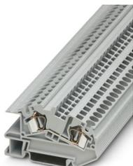
Morsetto per installazioni, tensione nominale: 400 V, corrente nominale: 32 A, Connessione a molla, 1. piano, Sezione di dimensionamento: 4 mm<sup>2</sup>, sezione: 0,08 mm<sup>2</sup> - 6 mm<sup>2</sup>, tipo di montaggio: NS 35/7,5, NS 35/15, colore: grigio
