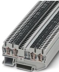
Morsetto passante, tensione nominale: 800 V, corrente nominale: 22 A, numero di connessioni: 4, tipo di connessione: Connessione a molla, Sezione di dimensionamento: 2,5 mm<sup>2</sup>, sezione: 0,08 mm<sup>2</sup> - 4 mm<sup>2</sup>, tipo di montaggio: NS 35/7,5, NS 35/15, colore: grigio
