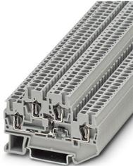
Componente morsetto componibile, La corrente massima è determinata dal diodo. Integrato: diodo 1N 4007, tensione di blocco: 1300V, corrente limite permanente: 0,5A., con diodo integrato, corrente nominale: 0,5 A, 1. e 2. piano, tipo di connessione: Connessione a molla, Sezione di dimensionamento: 2,5 mm<sup>2</sup>, sezione: 0,08 mm<sup>2</sup> - 4 mm<sup>2</sup>, montaggio: NS 35/7,5, NS 35/15, colore: grigio
