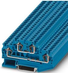
Morsetto a molla a due piani, tensione nominale: 500 V, corrente nominale: 30 A, tipo di connessione: Connessione a molla, 1. e 2. piano, Sezione di dimensionamento: 4 mm<sup>2</sup>, sezione: 0,08 mm<sup>2</sup> - 6 mm<sup>2</sup>, tipo di montaggio: NS 35/7,5, NS 35/15, colore: blu
