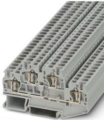
Morsetto a molla a due piani, tensione nominale: 500 V, corrente nominale: 30 A, tipo di connessione: Connessione a molla, 1. e 2. piano, Sezione di dimensionamento: 4 mm<sup>2</sup>, sezione: 0,08 mm<sup>2</sup> - 6 mm<sup>2</sup>, tipo di montaggio: NS 35/7,5, NS 35/15, colore: grigio
