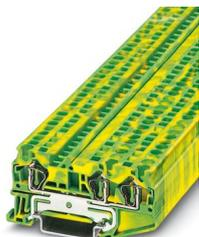
Morsetti comp. per conduttori terra, numero di connessioni: 3, tipo di connessione: Connessione a molla, 1. piano, sezione: 0,08 mm<sup>2</sup> - 6 mm<sup>2</sup>, tipo di montaggio: NS 35/7,5, NS 35/15, colore: giallo-verde
