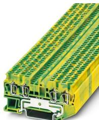
Morsetti comp. per conduttori terra, numero di connessioni: 4, tipo di connessione: Connessione a molla, sezione: 0,08 mm<sup>2</sup> - 1,5 mm<sup>2</sup>, tipo di montaggio: NS 35/7,5, NS 35/15, colore: giallo-verde
