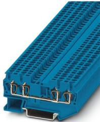
Morsetto passante, tensione nominale: 500 V, corrente nominale: 17,5 A, numero di connessioni: 4, tipo di connessione: Connessione a molla, Sezione di dimensionamento: 1,5 mm<sup>2</sup>, 1. piano, sezione: 0,08 mm<sup>2</sup> - 1,5 mm<sup>2</sup>, tipo di montaggio: NS 35/7,5, NS 35/15, colore: blu
