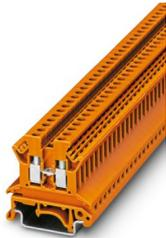
Morsetto passante, tensione nominale: 800 V, corrente nominale: 24 A, numero di connessioni: 2, tipo di connessione: Connessione a vite, Sezione di dimensionamento: 2,5 mm<sup>2</sup>, sezione: 0,2 mm<sup>2</sup> - 4 mm<sup>2</sup>, tipo di montaggio: NS 35/7,5, NS 35/15, NS 32, colore: arancione
