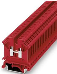
Morsetto passante, tensione nominale: 800 V, corrente nominale: 32 A, numero di connessioni: 2, tipo di connessione: Connessione a vite, Sezione di dimensionamento: 4 mm<sup>2</sup>, sezione: 0,2 mm<sup>2</sup> - 6 mm<sup>2</sup>, tipo di montaggio: NS 35/7,5, NS 35/15, NS 32, colore: rosso
