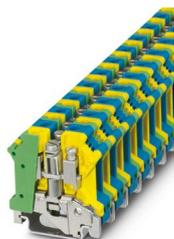
Morsetto per conduttore di terra per installazione, Blocco PE/N, costituito da un morsetto di terra verde-giallo e da un morsetto blu con ponticello a vite, tensione nominale: 400 V, corrente nominale: 57 A, numero di connessioni: 2, tipo di connessione: Connessione a vite, sezione: 0,2 mm<sup>2</sup> - 10 mm<sup>2</sup>, tipo di montaggio: NS 35/7,5, NS 35/15, NS 32, colore: verde-giallo-blu
