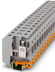
Morsetti di potenza, tensione nominale: 1000 V, corrente nominale: 150 A, numero di connessioni: 2, numero poli: 1, tipo di connessione: Connessione a vite, Sezione di dimensionamento: 50 mm<sup>2</sup>, sezione: 16 mm<sup>2</sup> - 70 mm<sup>2</sup>, tipo di montaggio: NS 35/7,5, NS 35/15, NS 32, NS 35/15-2,3, colore: grigio
