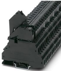
Morsetto portafusibili, tipo di fusibile: Vetro / ceramica / ..., tipo fusibile: G / 5 x 20, tensione nominale: 400 V, corrente nominale: 32 A, numero poli: 1, tipo di connessione: Connessione a vite, Sezione di dimensionamento: 4 mm<sup>2</sup>, sezione: 0,2 mm<sup>2</sup>- 4 mm<sup>2</sup>, tipo di connessione: Connessione a vite, sezione: 0,2 mm<sup>2</sup>- 4 mm<sup>2</sup>, tipo di montaggio: NS 35/7,5, NS 35/15, NS 32, colore: nero
