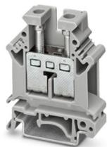
Morsetto passante, tensione nominale: 800 V, corrente nominale: 76 A, numero di connessioni: 2, numero poli: 1, tipo di connessione: Connessione a vite, Sezione di dimensionamento: 16 mm<sup>2</sup>, sezione: 2,5 mm<sup>2</sup> - 25 mm<sup>2</sup>, tipo di montaggio: NS 35/7,5, NS 35/15, NS 32, colore: grigio
