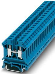
Morsetto passante, tensione nominale: 800 V, corrente nominale: 41 A, numero di connessioni: 2, tipo di connessione: Connessione a vite, Sezione di dimensionamento: 6 mm<sup>2</sup>, sezione: 0,2 mm<sup>2</sup> - 10 mm<sup>2</sup>, tipo di montaggio: NS 35/7,5, NS 35/15, colore: blu
