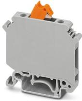
Morsetto con sezionatore a coltello, tensione nominale: 500 V, corrente nominale: 16 A, Corrente continua termica  $I_{th}$ : 16 A, tipo di connessione: Connessione a vite, Sezione di dimensionamento: 2,5 mm<sup>2</sup>, sezione: 0,2 mm<sup>2</sup> - 6 mm<sup>2</sup>, montaggio: NS 35/7,5, NS 35/15, NS 32, colore: grigio
