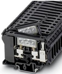
Morsetto portafusibili, tipo di fusibile: Vetro / ceramica / ..., tipo fusibile: G / 6,3 x 32, tensione nominale: 24 V, corrente nominale: 10 A, numero poli: 1, tipo di connessione: Connessione a vite, Sezione di dimensionamento: 1,5 mm<sup>2</sup>, sezione: 0,5 mm<sup>2</sup>- 16 mm<sup>2</sup>, tipo di montaggio: NS 35/7,5, NS 35/15, NS 32, colore: nero
