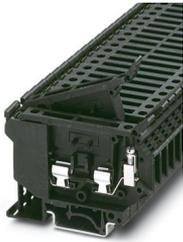
Morsetto portafusibili, tipo di fusibile: Vetro / ceramica / ..., tipo fusibile: G / 5 x 20 / 5 x 25 / 5 x 30, tensione nominale: 800 V, corrente nominale: 6,3 A, numero poli: 1, tipo di connessione: Connessione a vite, Sezione di dimensionamento: 4 mm<sup>2</sup>, sezione: 0,2 mm<sup>2</sup>- 4 mm<sup>2</sup>, tipo di montaggio: NS 35/7,5, NS 35/15, NS 32, colore: nero
