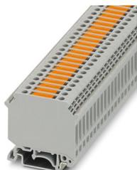
Morsetto con sezionatore a coltello, con viti per prese di prova per l'alloggiamento di spine di prova, tensione nominale: 500 V, corrente nominale: 16 A, 1. piano, tipo di connessione: Connessione a vite, Sezione di dimensionamento: 2,5 mm<sup>2</sup>, sezione: 0,2 mm<sup>2</sup> - 6 mm<sup>2</sup>, montaggio: NS 35/7,5, NS 35/15, NS 32, colore: grigio
