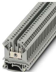
Morsetto passante, tensione nominale: 800 V, corrente nominale: 24 A, numero di connessioni: 2, tipo di connessione: Connessione a vite, 1. piano, sezione: 0,2 mm<sup>2</sup> - 4 mm<sup>2</sup>, tipo di montaggio: NS 32, NS 35/15, NS 35/7,5, colore: grigio
