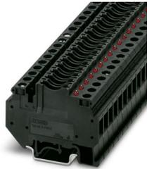
Morsetto portafusibili, tipo di fusibile: Piatta, tipo fusibile: C, tensione nominale: 24 V, corrente nominale: 30 A, numero poli: 1, tipo di connessione: Connessione a vite, 1. piano, Sezione di dimensionamento: 4 mm<sup>2</sup>, sezione: 0,2 mm<sup>2</sup>- 10 mm<sup>2</sup>, tipo di montaggio: NS 35/7,5, NS 35/15, NS 32, colore: nero
