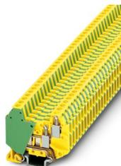
Morsetti comp. per conduttori terra, In caso di affiancamento con morsetti passanti dal profilo identico, in presenza di tensioni di isolamento 320 V, occorre impiegare una piastra terminale., numero di connessioni: 4, tipo di connessione: Connessione a vite, sezione: 0,14 mm<sup>2</sup> - 1,5 mm<sup>2</sup>, tipo di montaggio: NS 15, colore: giallo-verde
