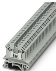
Morsetto passante, tensione nominale: 690 V, corrente nominale: 24 A, numero di connessioni: 2, tipo di connessione: Connessione a vite, sezione: 0,2 mm<sup>2</sup> - 4 mm<sup>2</sup>, tipo di montaggio: NS 35/7,5, NS 35/15, colore: grigio
