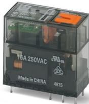
Relè in miniatura ad innesto, con contatto di potenza, 1 contatto di scambio, tasto di prova, segnalazione meccanica di stato, LED di stato, tensione d'ingresso 24 V AC
