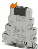
PLC-INTERFACE per funzioni di output, composta da morsetto base PLC-BSC.../ACT con connessione a vite e relè a stato solido in miniatura a innesto, per il montaggio su guida di montaggio NS 35/7,5, 1 contatto aperto a riposo, ingresso: 24 V DC, uscita: 24-253 V AC/2 A
