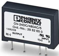
Relè statico per l'amplificazione del segnale e la separazione galvanica tra il circuito di comando e il campo, innestabile sullo zoccolo SIM-AMS o con connessione per scheda per montaggio diretto su circuito stampato, ingresso: 4-32 V DC, uscita: 12-530 V AC/ 5 A
