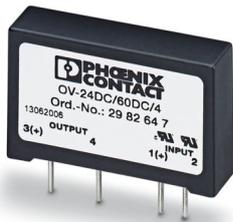
Relè statico per l'amplificazione del segnale e la separazione galvanica tra il circuito di comando e il campo, innestabile sullo zoccolo SIM-AMS o con connessione per scheda per montaggio diretto su circuito stampato, ingresso: 4,25-32 V DC, uscita: 1-60 V DC/4 A
