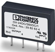
Relè statico per l'amplificazione del segnale e la separazione galvanica tra il circuito di comando e il campo, innestabile sullo zoccolo SIM-AMS o con connessione per scheda per montaggio diretto su circuito stampato, ingresso: 4,25-32 V DC, uscita: 1-350 V DC/1 A
