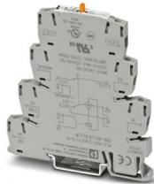
PLC-INTERFACE con interruttore (utilizzo manuale) per le funzioni "Manuale, Zero e Automatico", con connessione a vite e relè a contatto di potenza integrato, per il montaggio su guida di montaggio NS 35/7,5, 1 contatto aperto a riposo, tensione in ingresso 24 V AC/DC
