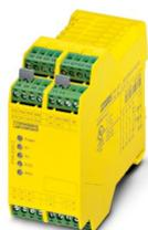
Modulo di sicur. per controllo per arresti d'emerg. e finecorsa ripari fino a SIL 3 o cat. 4, PL e secondo EN ISO 13849, attivaz. automatica o manuale, 3 contatti in chiusura, 1 contatto in apertura, 2 contatti in chiusura con ritardo alla diseccitaz. da 1,0 s fissi, morsetti con connessione a vite estraibili
