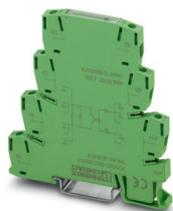
PLC-INTERFACE, relè a stato solido integrato, con connessione a molla, per il montaggio su guida di supporto NS 35/7,5, ingresso: 60 V DC, uscita: 12-300 V DC/1 A
