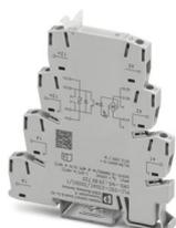
PLC-INTERFACE, relè a stato solido integrato, con connessione a vite, per il montaggio su guida di supporto NS 35/7,5, ingresso: 230 V AC, uscita: 12-300 V DC/1 A
